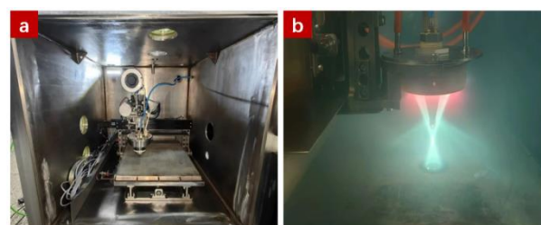
图17 基于冷阴极电子枪的增材制造设备 (a); 冷阴极电子枪对合金的熔融过程 (b)
