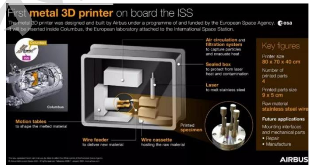
图13 国际空间站搭载的金属增材制造机 [29]
