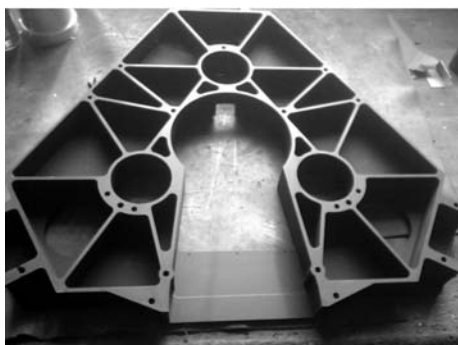
图 5 根据拓扑优化结果设计的相机主承力基板 内部竖筋布局
