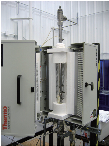
图 7 美国约翰逊航天中心模拟月壤氢还原制水实验装置
