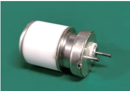
图 3 阴极测试结构 Fig. 3 Cathode test structure
