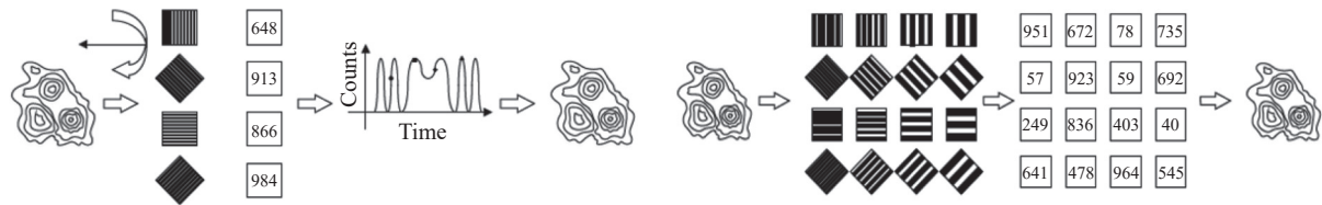
图 1 时间调制傅里叶与空间调制傅里叶的成像原理
