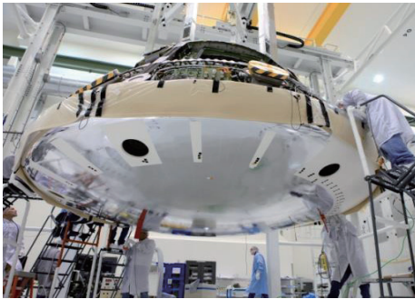
图 14 猎户座探测飞船的隔热大底
